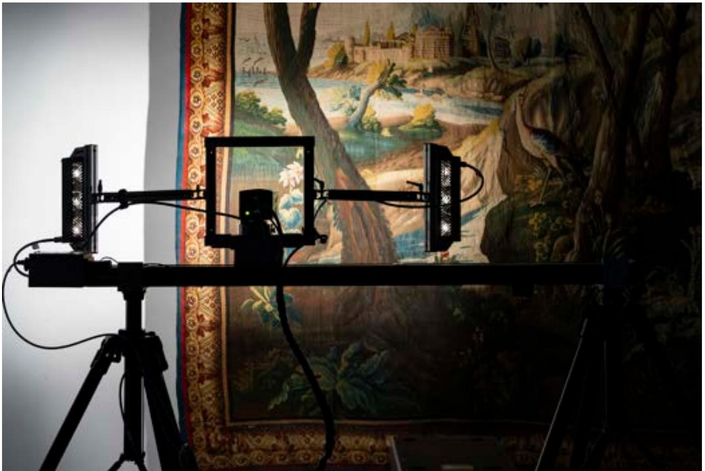
Acquisition d'une image à l'aide d'une caméra hyperspectrale qui permet de mesurer la façon dont les ondes lumineuses sont réfléchies par les fibres d'une tapisserie du XVIII<sup>e</sup> siècle, conservée à la Cité internationale de la tapisserie d'Aubusson.
